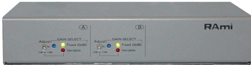
Le **VCA 200**, inséré dans une chaîne d'amplification permet de régler le niveau sonore à distance. Il comprend deux canaux distincts pouvant être utilisés, soit en stéréo (mise en parallèle des deux commandes), soit en deux fois mono.
