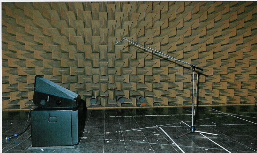
**Eine 45N-12 mit L600 Subwoofer als Drumfill auf der Messposition im reflexionsarmen Raum. Auch in dieser Anwendung hilft der seitlich scharf begrenzte Beam, den Monitorpegel aus den Drum-Mics zu halten.**
