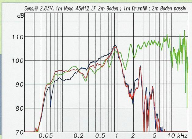
**Abb. 1:** Ungefensterte (also inkl. der Bodenreflexionen) Messungen des LF-Weges in der 45N-12: rot = Monitorposition auf dem Boden, grün = in passiver Betriebsart auf dem Boden, blau = als Drumfill auf einer L600. In der Bodenposition gewinnt der Tieftöner unterhalb von 200 Hz durch die Bodenkopplung. Darüber hinaus kommt es zu einigen Einbrüchen durch die Bodenreflexion (siehe Text).
