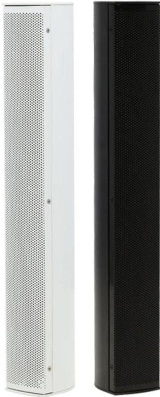
Die Spik 2c ist eine schlanke Tonsäule mit acht fullrange 2-Zoll Treibern und einer festen Abstrahlcharakteristik von 110°x12°. Betrieben wird die Tonsäule mit einem integrierten digitalen Verstärkermodul und DANTE Netzwerkinterface. Es wird also nur ein Netzkabel benötigt für die Stromversorgung mittels PoE+ und das DANTE-Signal !
