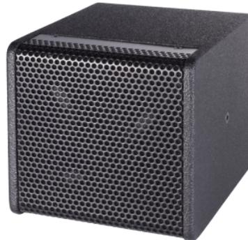
Der Spik 5 ist ein kompakter koaxialer 2-Wege Lautsprecher mit eingebautem Verstärkermodul und DANTE Netzwerkinterface. Die Stromversorgung geschieht mittels PoE+ und das Audiosignal kommt via DANTE. Zudem hat der Lautsprecher einen Schalter für die Umstellung auf passiven Betrieb mittels externem Verstärker.
