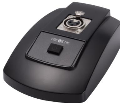
Der MiK ist ein Mikrofon-Tischsockel mit integriertem DANTE Interface mit PoE Stromversorgung. Er ist solide gebaut und bietet so die optimale Basis für jegliche Schwanenhals-Mikrofone mit XLR Anschluss.
